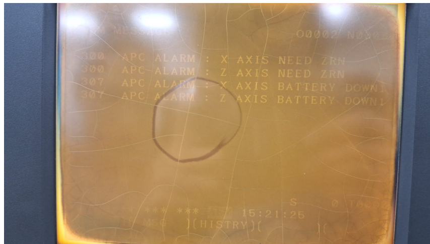
Figura 10.1: Daño en la batería del Torno CNC
