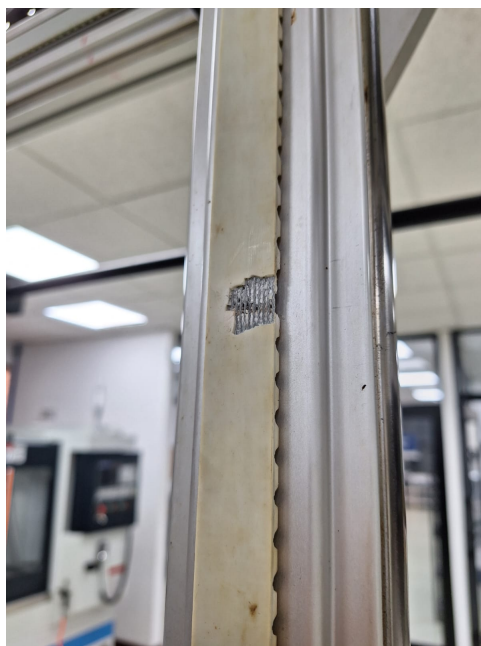
Figura 10.5: Daño en la correa del ASRS
