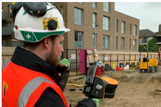
Figura 15. Levantamiento con equipo SLAM LiDAR (Skyviv. s.f.).
