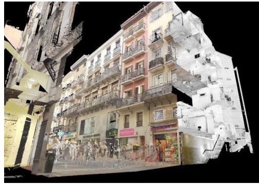
Figura 12. Escáner Láser 3D a) medición con Escáner Láser 3D y b) ejemplo nube de puntos levantada con TLS (Fovea. s.f.).
