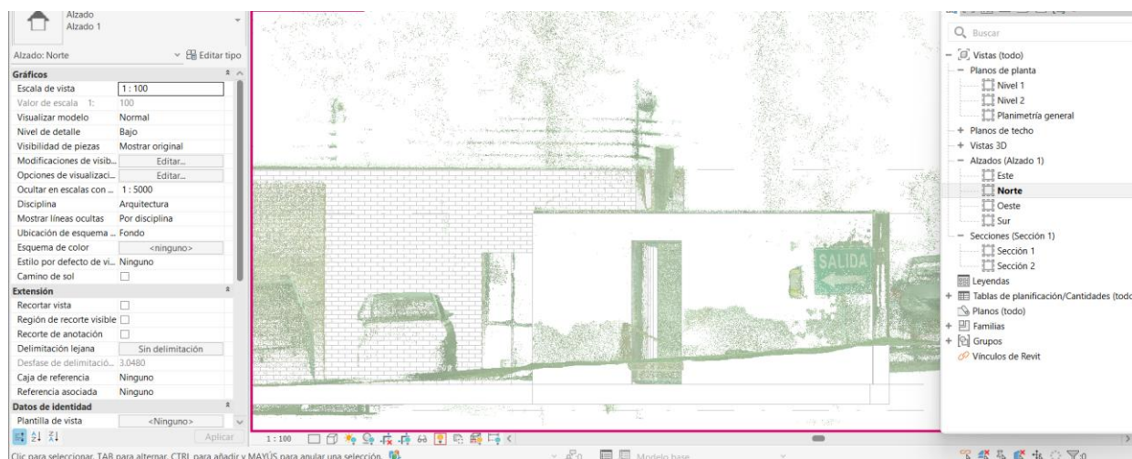
Figura 39. Dibujo de muros a diferente nivel con base en la nube de puntos SLAM. Fuente: elaboración propia.
