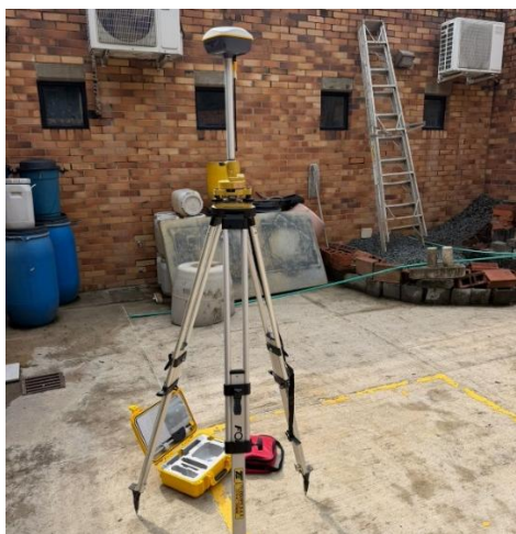
Figura 32. a) Dispositivo Base Ajustado y Montado en Trípode, y b) Rover Acoplado al Bastón. Fuente: elaboración propia
