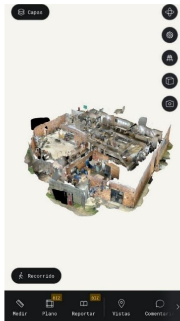
Figura 57. Visualización después del procesamiento en Polycam. Fuente: elaboración propia.
