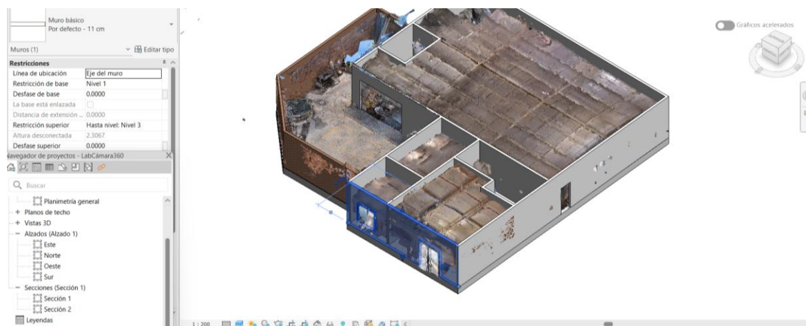
Figura 54. Espacios y puertas en los muros desde la nube de puntos Cámara 360°. Fuente: elaboración propia.
