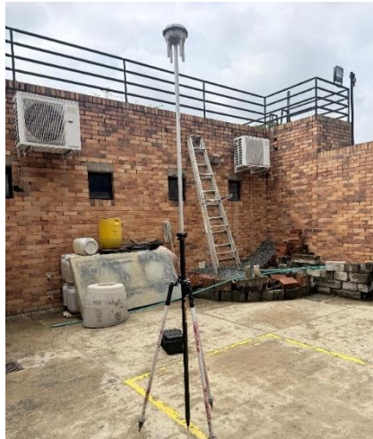
Figura 67. Antena RTK ubicada a 2,50 m de altura sobre el punto de control. Fuente: elaboración propia.
