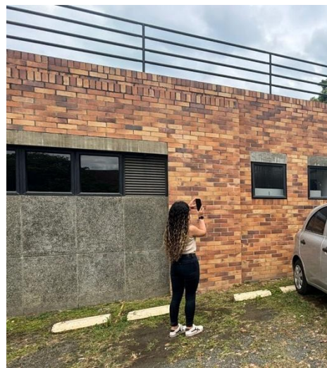
Figura 55. Toma de datos con iPhone LiDAR; a) visualización Polycam, b) toma de datos en campo. Fuente: elaboración propia.
