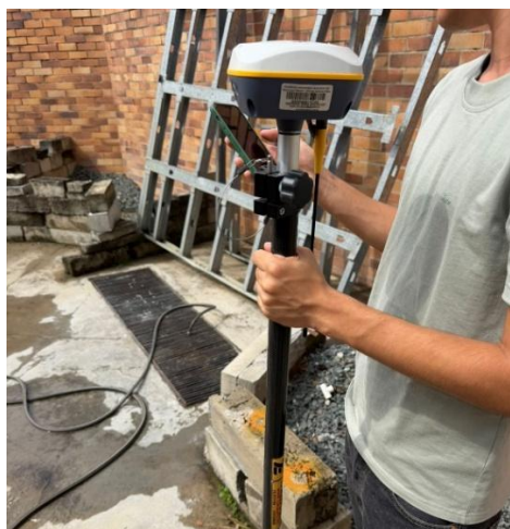
Figura 32. a) Dispositivo Base Ajustado y Montado en Trípode, y b) Rover Acoplado al Bastón. Fuente: elaboración propia
