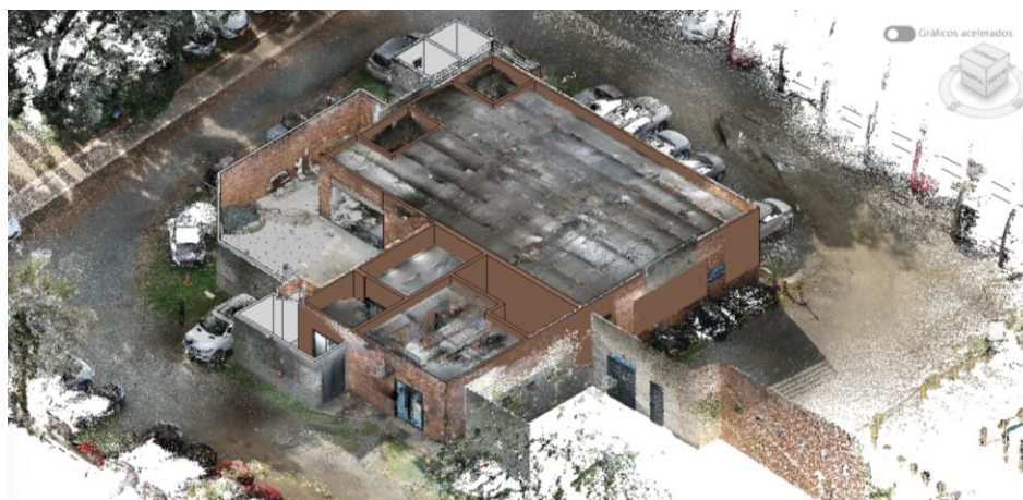
Figura 91. Vista general de la nube de puntos SLAM del Laboratorio de Mezclas perspectiva exterior e interior, cobertura completa alcanzada con esta técnica. Fuente: elaboración propia.
