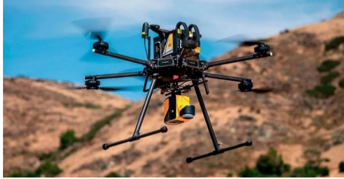
Figura 16. Combinación de tecnología LiDAR (láser) con UAVs (YellowScan. s.f.)
