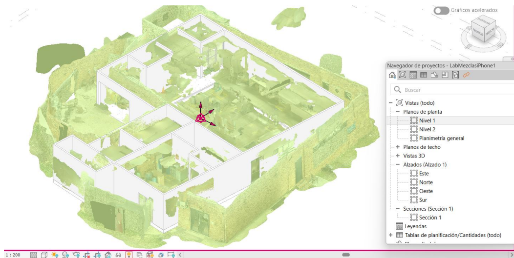
Figura 63. Dibujo de muros internos con base en la nube de puntos iPhone. Fuente: elaboración propia.
