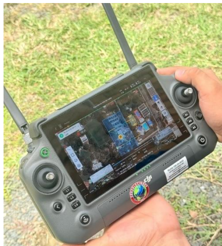
Figura 69. Planificación de la ruta de vuelo sobre el área del laboratorio. Fuente: elaboración propia.
