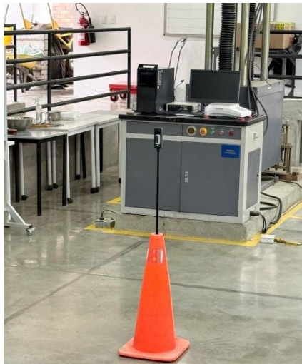
Figura 42. Montaje de la cámara Insta360 X3 sobre bastón y cono de señalización. Fuente: elaboración propia.
