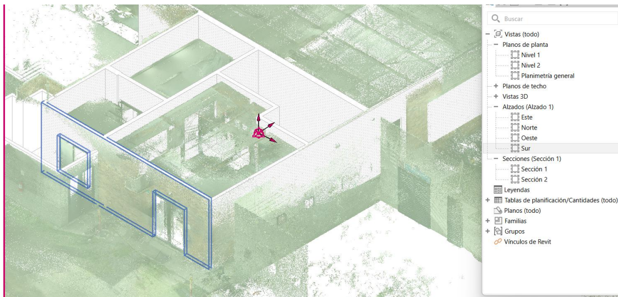
Figura 41. Espacios y puertas en los muros desde la nube de puntos SLAM. Fuente: elaboración propia.
