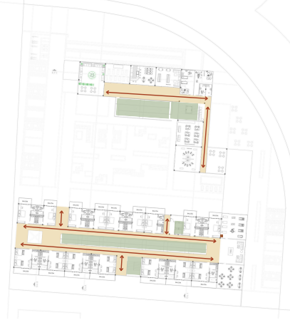
Circulación planta segundo piso
