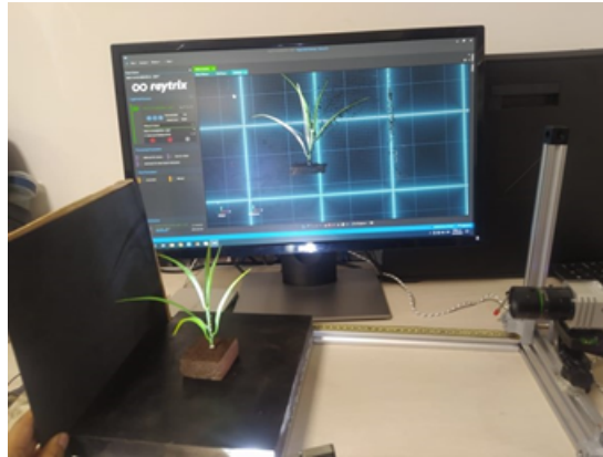
Figura 3.2: Configuración de la cámara plenóptica y objeto en la estructura de la Figura 3.1
