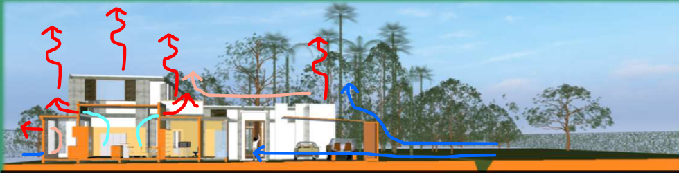
Vientos mas fríos y húmedos provenientes del la vegetación ingresan producto de la presión negativa generada por las zonas de ventilación caliente ascendentes.
