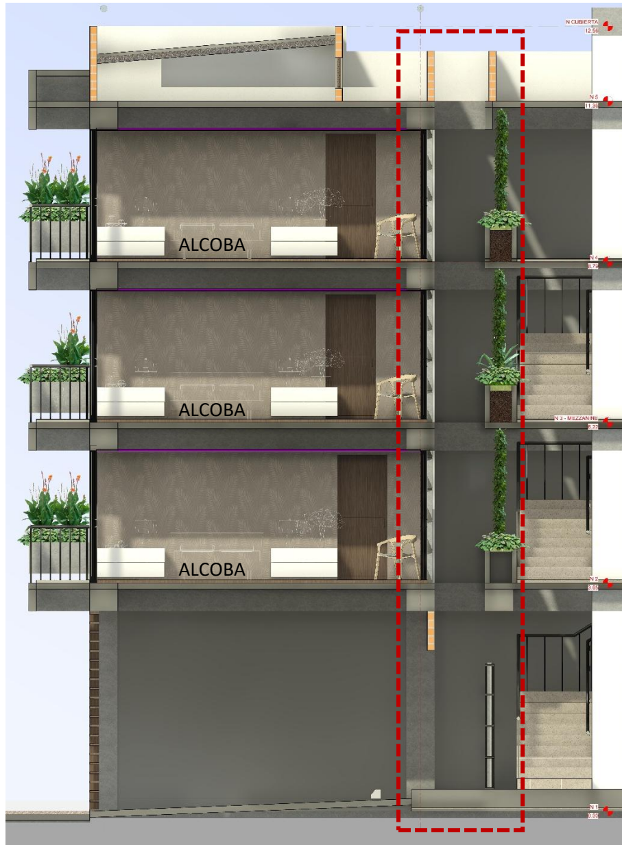
Figura 87. Corte por fachada – Patio frío- estrategia bioclimática.
