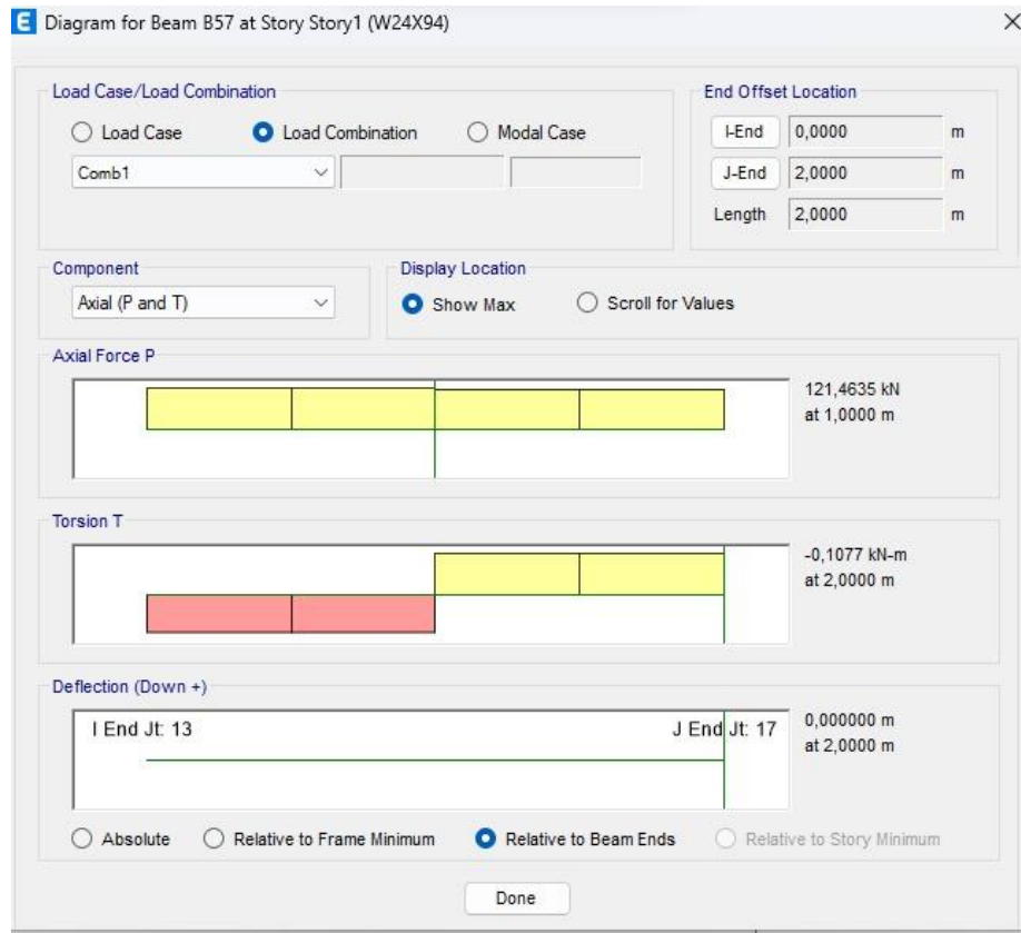
Ilustración 94 diagrama de esfuerzos axiales máximos en la cercha
