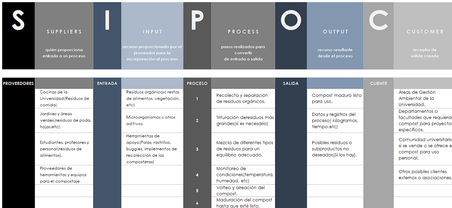
Figura 12. Sistema SIPOC para el proceso de producción de compostaje de la compostera de la cancha de fútbol de la PUJ Cali
