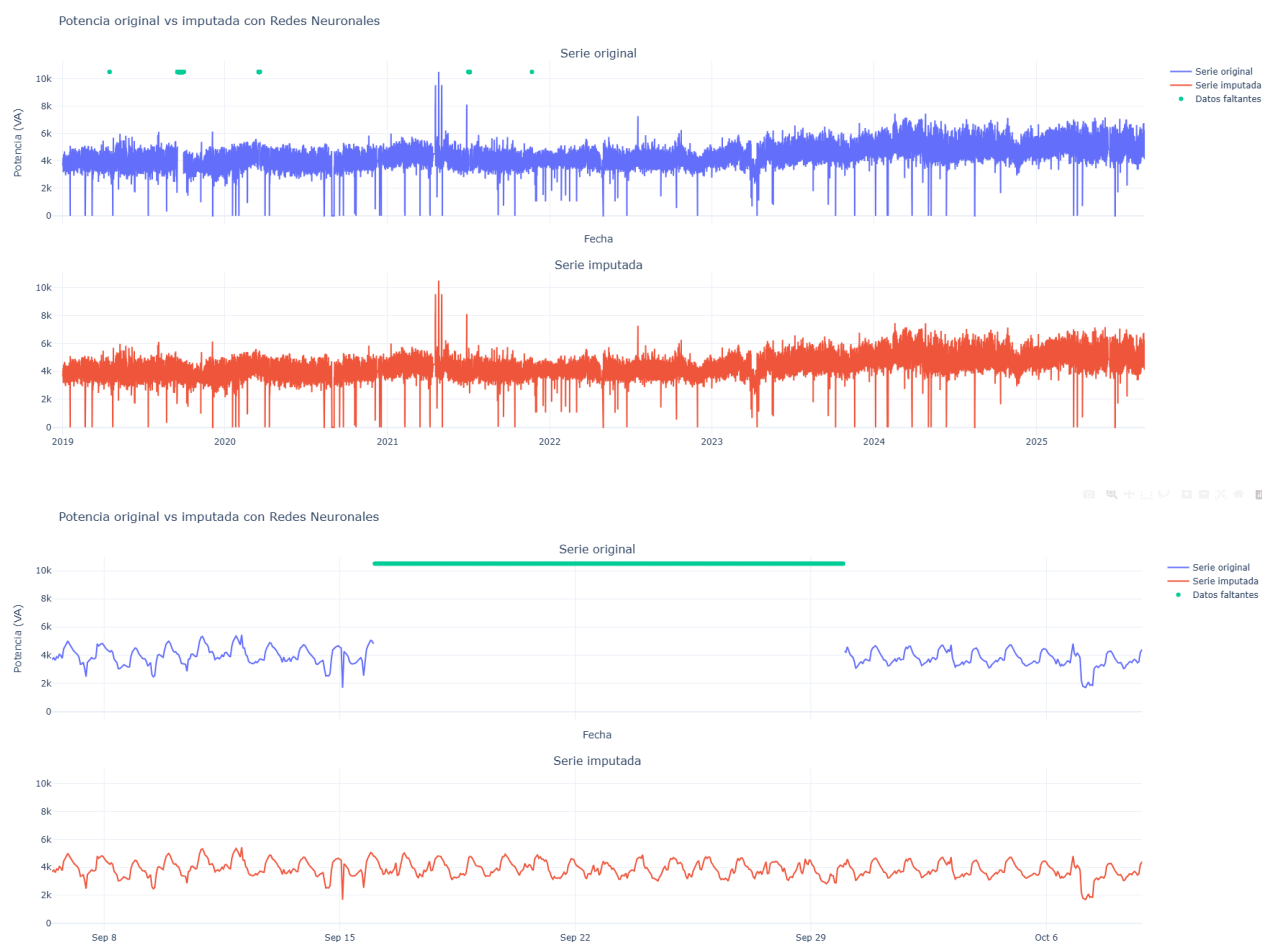
Figura 3. Comparación visual de métodos de imputación seleccionados sobre el intervalo de 335 horas (septiembre 2019)
