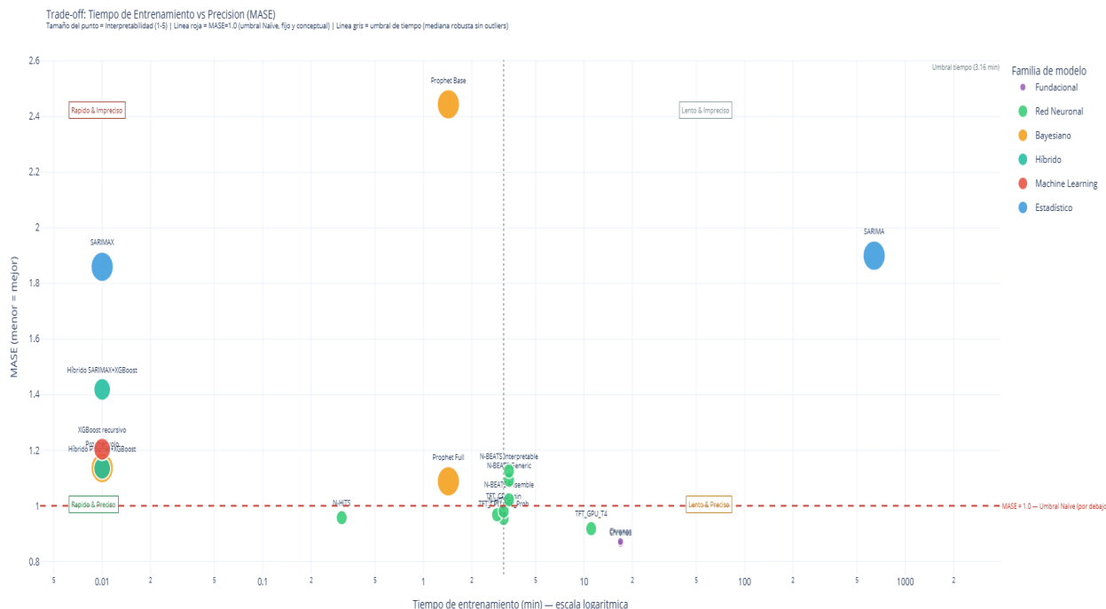
Figura 23. Diagrama de dispersión de cuadrantes eficiencia-precisión (tiempo vs. MASE)
