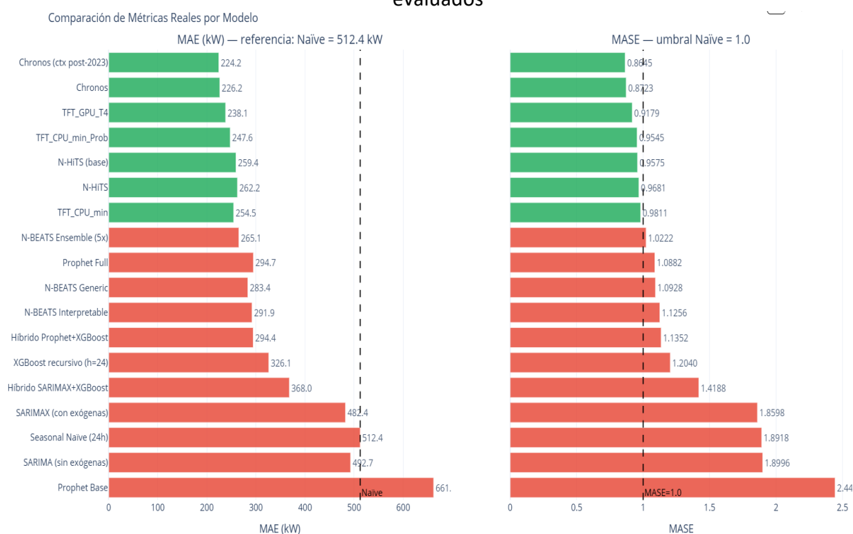
Figura 21. Gráfico de barras horizontales del ranking de MAE y MASE de todos los modelos evaluados
