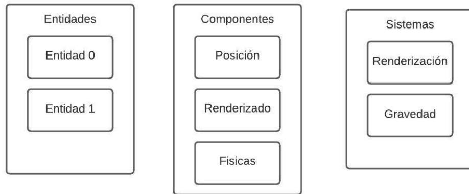
Figura 13. Patrón entidad, componentes, sistemas. Las entidades tienen componentes y los sistemas actúan sobre las entidades.
