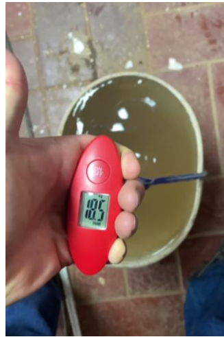
Figura 19. Proceso de medición con cuñete, agua y medidor portátil (El Autor, 2023).
