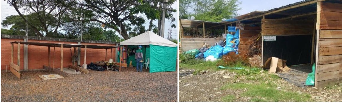
Figura 32. Prototipo de separación de residuos en sitio temporal de RCD. Fuente: El Autor; M Alejandro Rojas M, 2023
