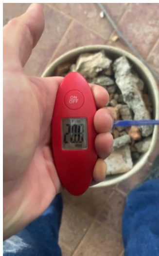
Figura 20. Balde lleno con residuos mezclados de la obra para ser pesados (El Autor, 2023).
