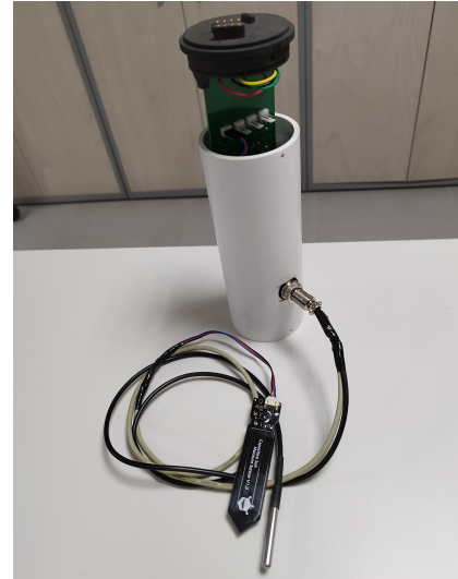
Figura 4. Ensamble PCB y sensores.
