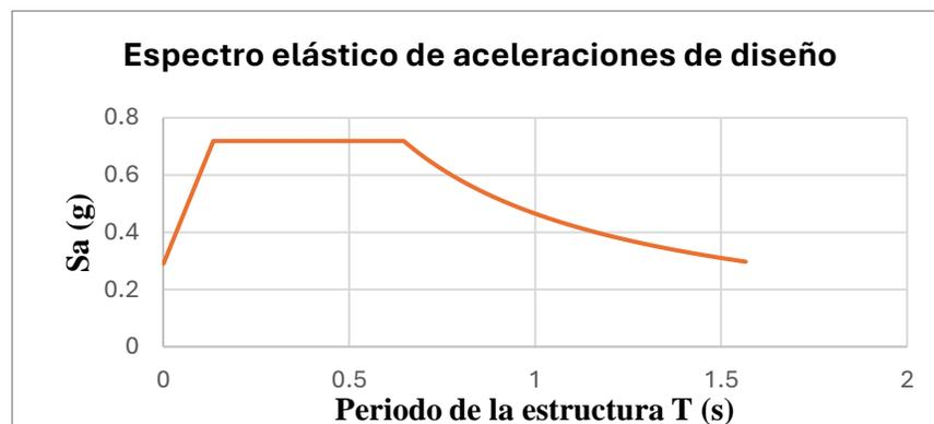
**Ilustración 1. Espectro elástico de aceleraciones para chequeos**
