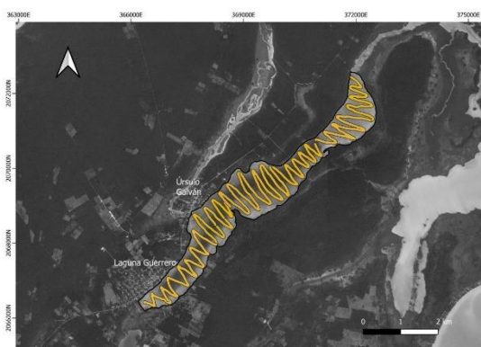
Figura 2. la suma de transectos realizados para el muestreo batimétrico con el SBL em Laguna Guerrero.
