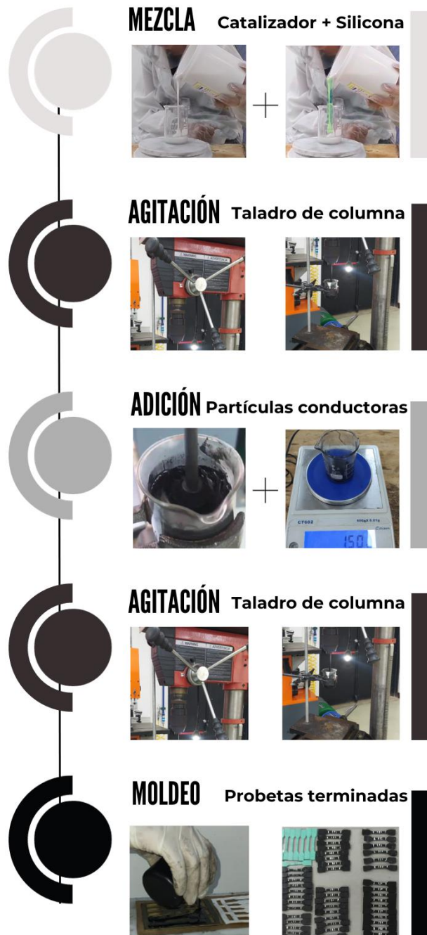
Fig.16 : Diagrama paso a paso del proceso de obtención de los materiales.
