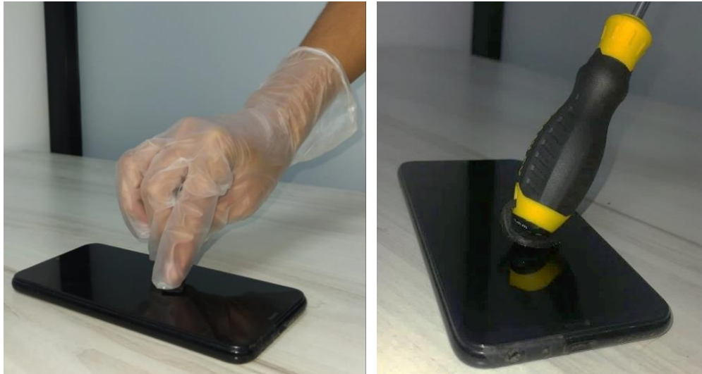
Fig.34 : Prueba interacción: a) Con guante aislante b) Con polímero aislante
