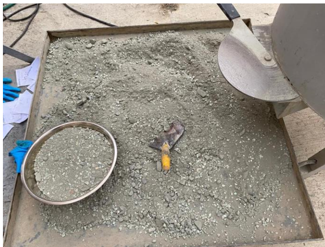
Figura 19- Material de afirmado A25 con inclusión de zeolitas mezclado Nota. Fuente: Elaboración propia
