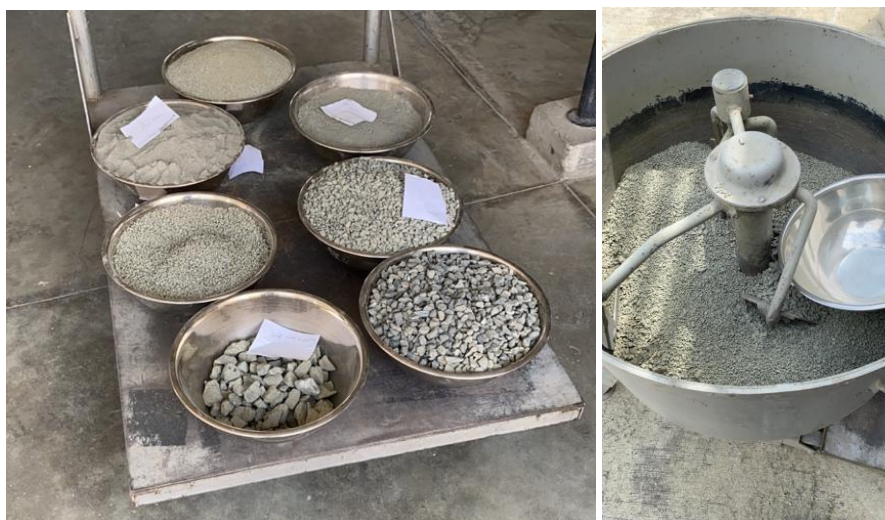
Figura 10- Construcción de curva granulométrica afirmado A25
