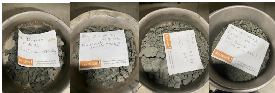
Figura 11 - Humedades de moldeo para construcción de curva de compactación
