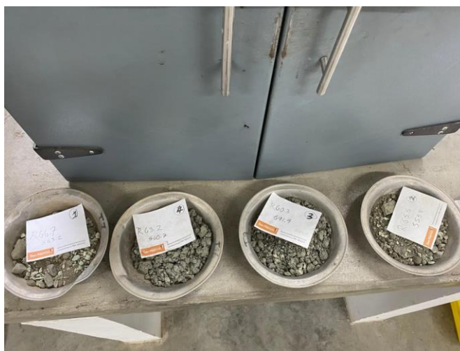
Figura 21 - Determinación de humedades de moldeo para elaborar curva de compactación
