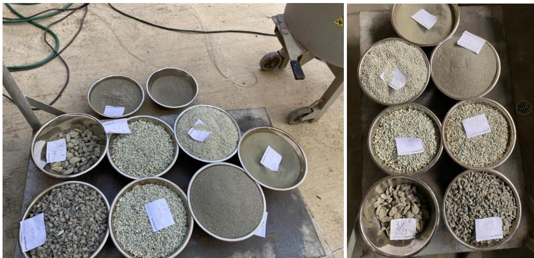
Figura 18-Materiales para construcción de afirmado con inclusión de zeolitas A2 Nota. Fuente: Elaboración propia
