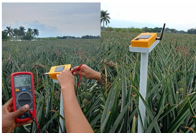
Figura 3. Instalación final de un nodo sensor y prueba de panel solar.
