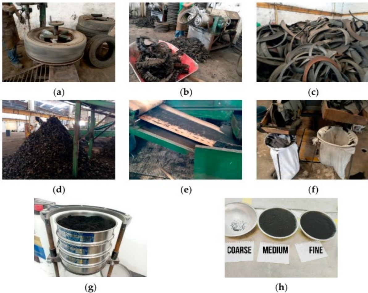
Figura 2. Proceso de reciclaje de neumáticos de vehículos: (a) Selección de neumáticos y corte de flancos, (b) Corte de talón proceso, (c) léase cortado en tiras, (d) trituración inicial, (e) molienda y eliminación del acero restante, (f) Tamizado inicial y empaque, (g) tamizado mecánico y (h) Distribución del tamaño de partícula. (Meza-Muñoz et al., 2024)
