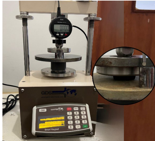
Figura 18. Montaje de las probetas para relajamiento.
