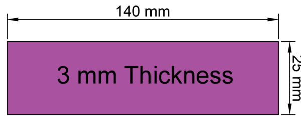
Figura 4. Forma de la probeta de tensión (ASTM D412).
