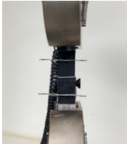
Figura 5. Montaje experimental de tensión (ASTM D412).
