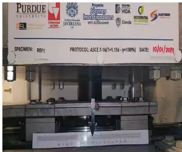
Figura 32. Montaje experimental de corte cíclico (Velasco-Cuervo, 2024).
