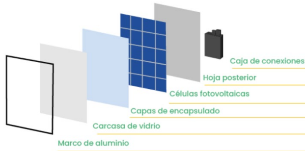
Figura 4. Composición general de un módulo FV (Adaptado de [11])
